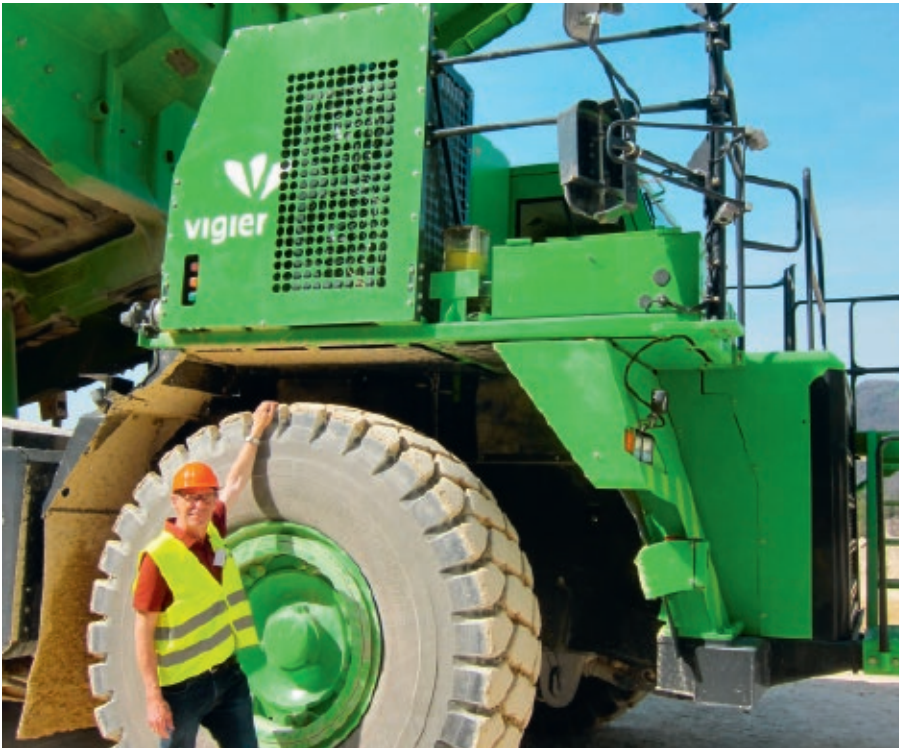
Der grösste Elektrolaster der Welt steht im Steinbruch Vigier Ciment im Einsatz
